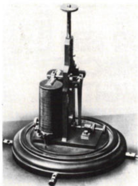
Afb. 3. Het telegrafierelais, geconstrueerd door Werner von Siemens in 1847.
