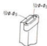
Fig. 15. Magneetspoel met kortsluitring.
